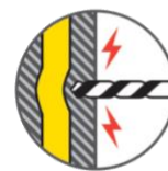
Механическое повреждение изоляции
